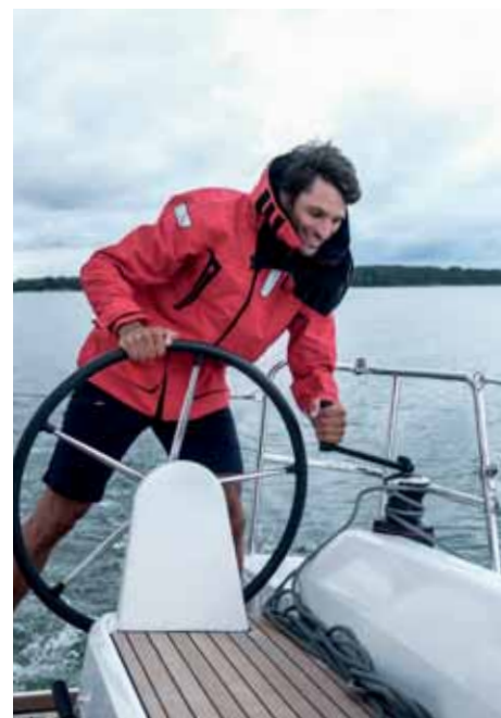
Vinšny na ořeže geny jsou umístěny těsně před kormidlem, takže obraty i trim zvládne sám kormidelník.
