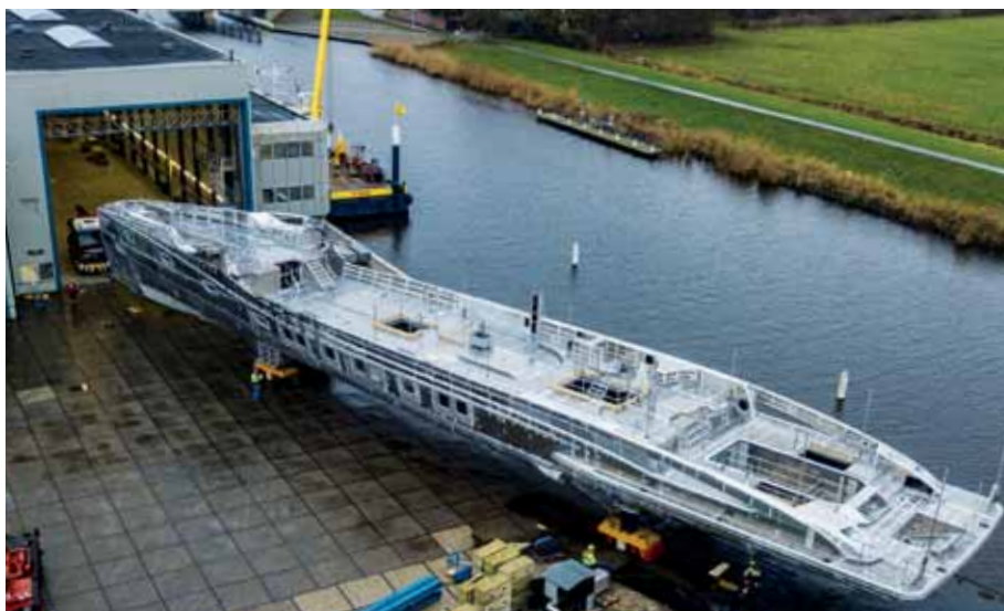
Na konci loňského roku byl trup PHI spojen s nástavbou a jachta byla přesunuta do největší haly loděnice, která zajistí dostatečný prostor pro její dokončení a finální vyšperkování.
