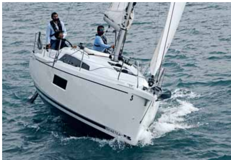
Díky hlubokému kýlu, optimalizovanému tvaru trupu z dílny Pascala Conqa a dvěma kormidelním listům se loď snadno kormidluje a dobře drží směr i v náklonu.
