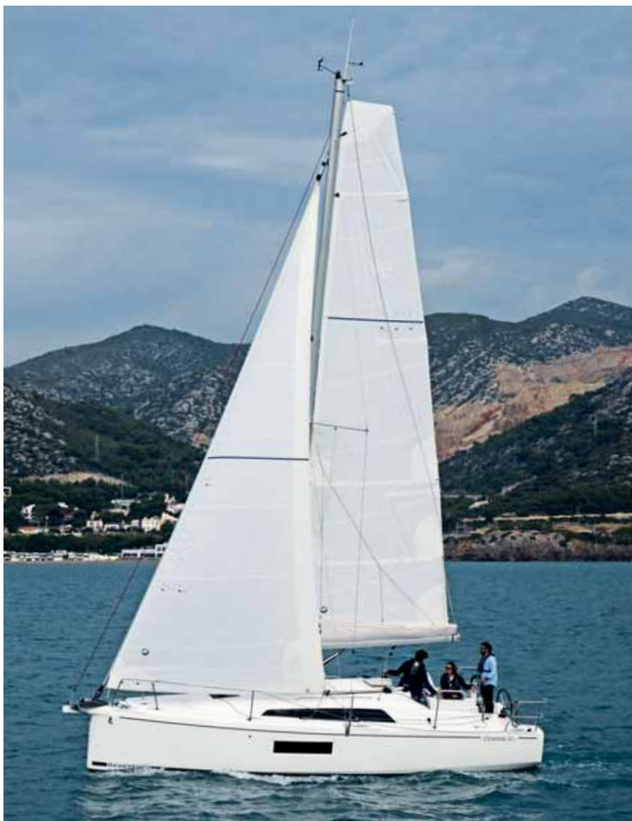
Takeláž bez zadního stěhu dovoluje použití velké hlavní plachty s roachem s horními průběžnými spírami a lazy jackem.
