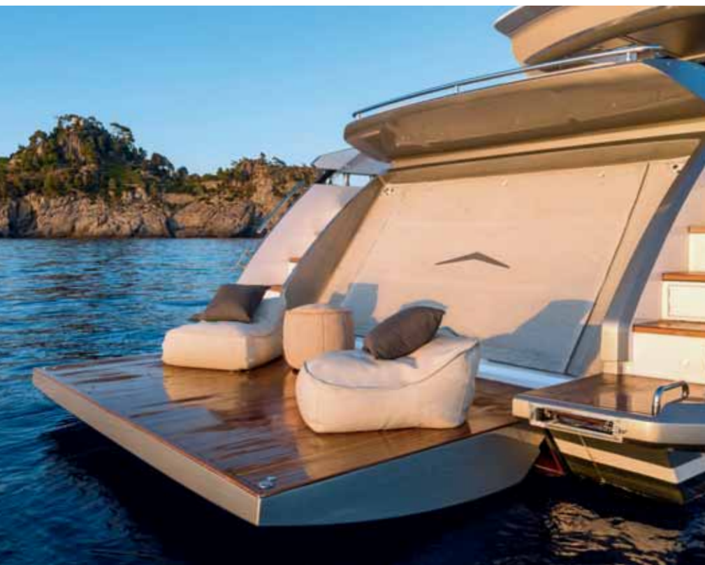
Za výklopnou koupací plošinou se skrývá hangár, který pojme pomocný člun i vodní skútr.
