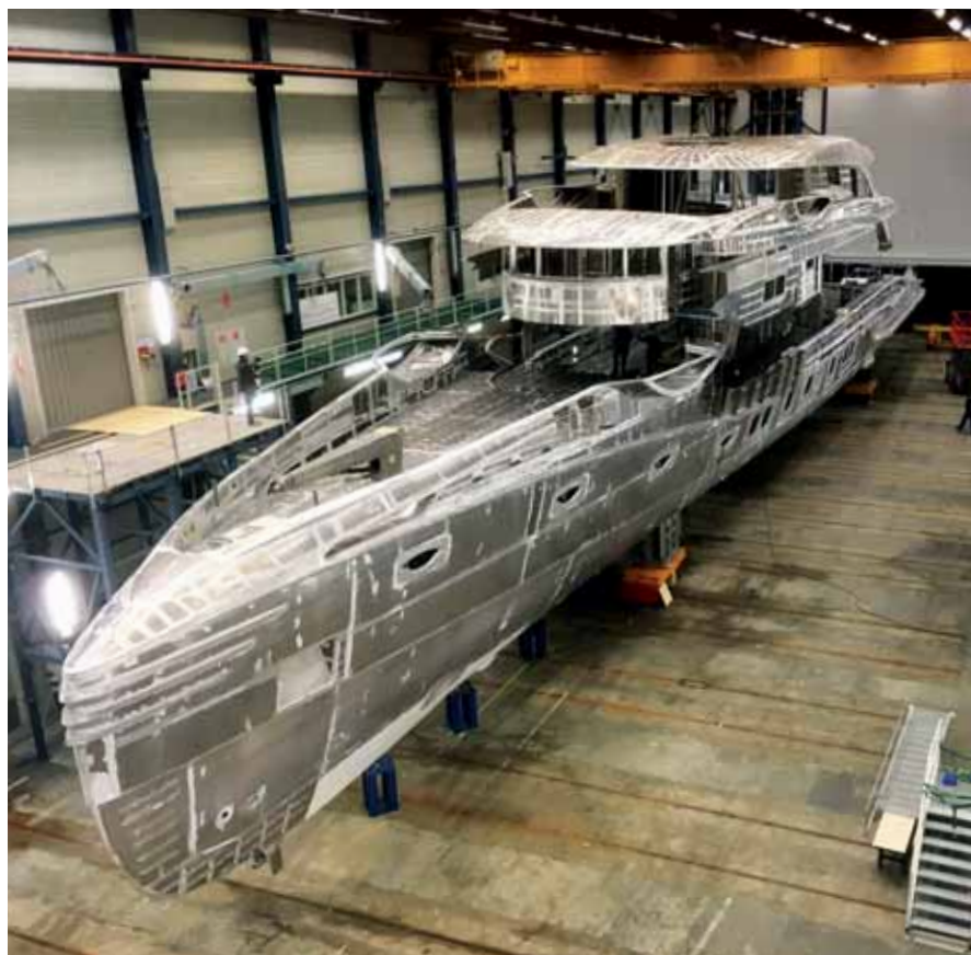
V ateliéru Van Oossanen vyvinuli pro PHI speciální tvar trupu Fast Displacement XL®, který umožní stavbu lodí delších než 55 metrů a přitom zachová celkovou hmotnost pod hranici 500 GT.
