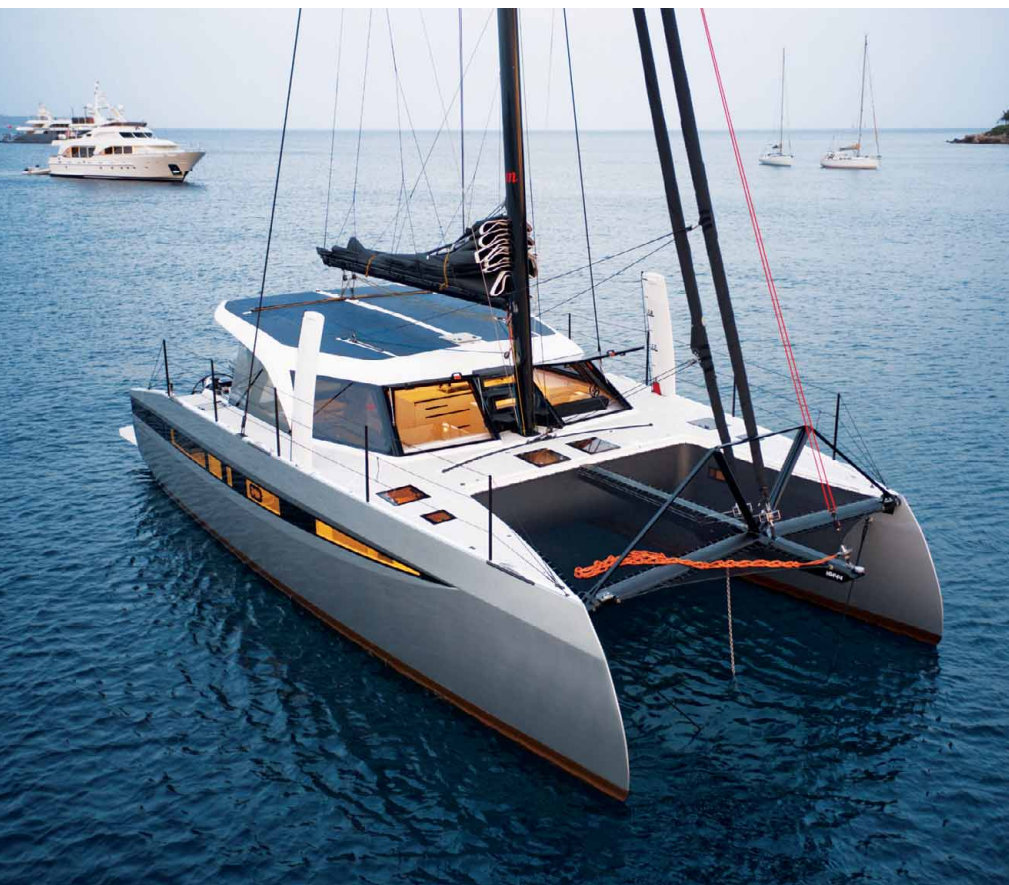
Na střeše nástavby jsou umístěny fotovoltaické články o celkovém výkonu 3,9 kW.
