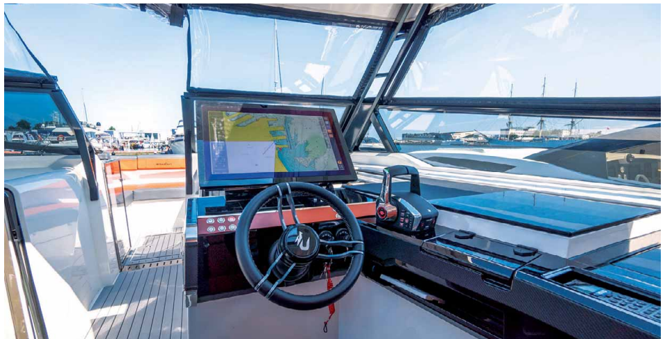
Řídicí stanoviště je umístěno na pravoboku a vévodí mu ohromný displej, kde je možné zobrazit nejen mapu, ale i všechny další potřebné údaje.
